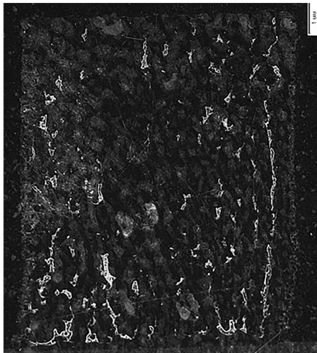
Рис. 6. Дефекты несплавления на образце №18
