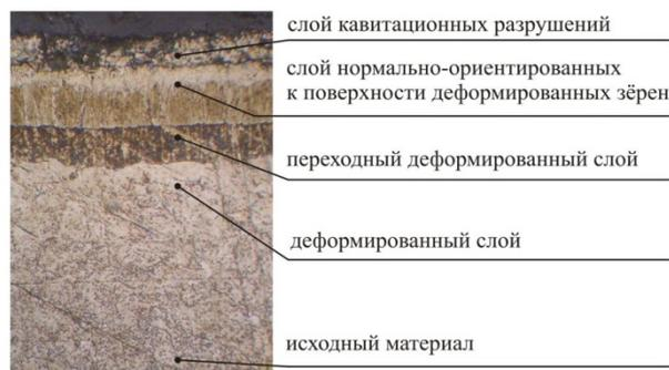
Рис. 3. Структура материала после кавитационной обработки
