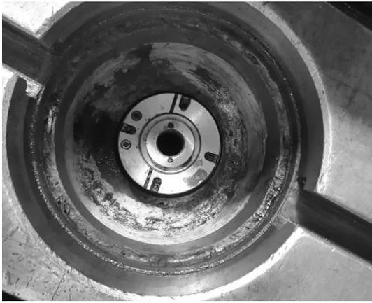
Рис. 3. Место установки датчика угла поворота стола
