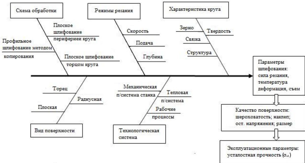
Рис. 4. Причинно-следственные связи условий обработки и качества поверхностного слоя при глубинном шлифовании
