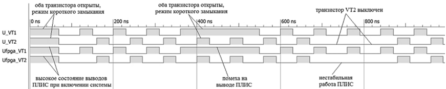
Рис. 3. Сигналы управления, характерные для аварийного режима
