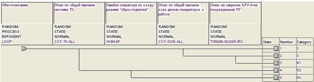
Рис. 1. Пример разрабатываемого дерева событий
