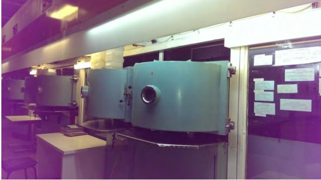
Рис. 2. Камера загрузки установки ионного легирования «Везувий-3М»
