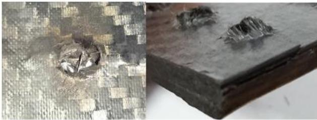
Рис. 3. Вид кромок образцов углепластика после сверления 40...50-ти отверстий
