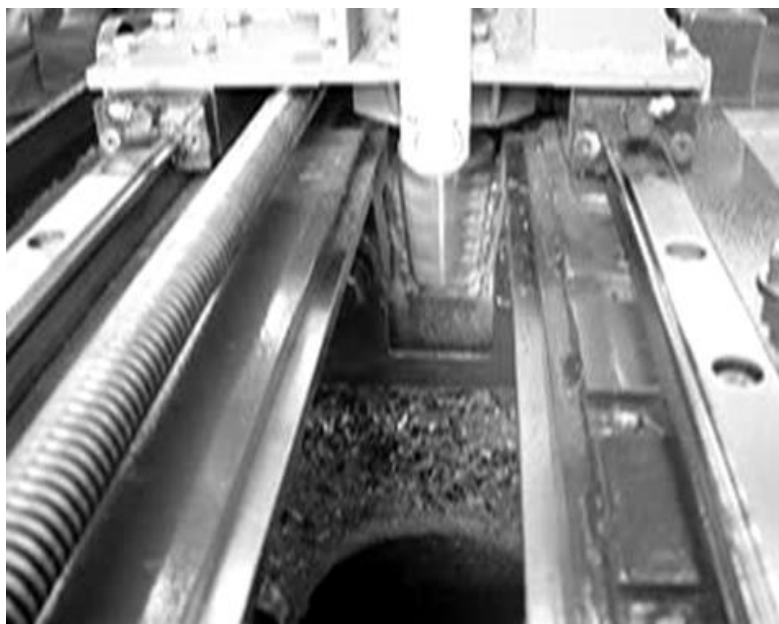
Рис. 5. Фрезерование клинового паза после восстановления наплавкой модульной концевой фрезой на портативном станочном модуле
