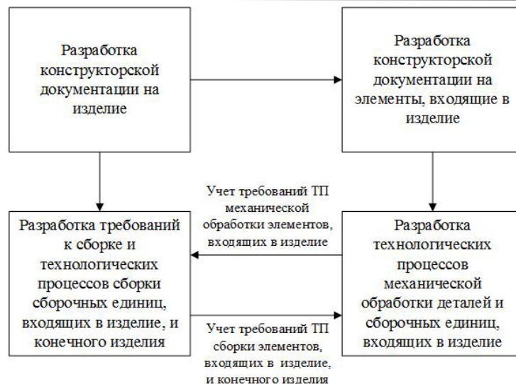
Рис. 1. Связь между технологической подготовкой механообрабатывающего и сборочного производств
