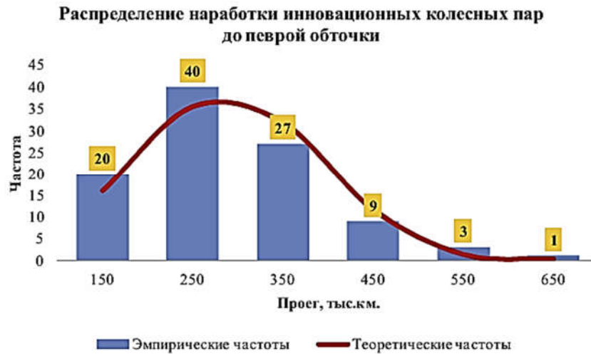
Рис. 8. График распределения наработки инновационных колесных пар до первой обточки Fig. 8. Chart of distribution of running hours for innovative wheelsets before the first reprofiling
