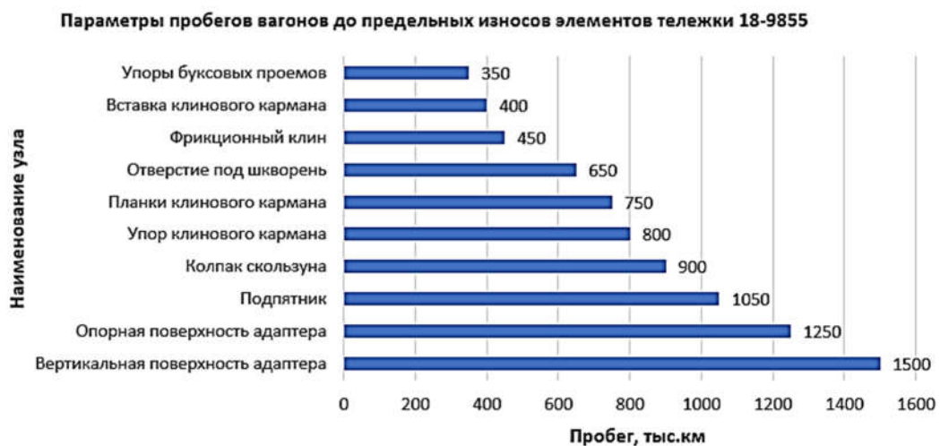
Рис. 7. Параметры пробегов вагонов до предельных износов элементов тележки 18-9855
