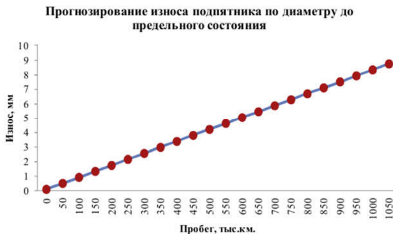
Рис. 3. График прогнозирования износа подпятника по диаметру до предельного состояния Fig. 3. Forecast plot of axial bearing wear by diameter to limit state
