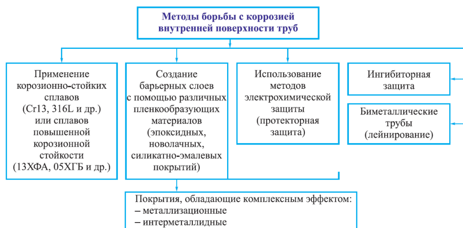
Рис. 1. Классификация методов борьбы с коррозией внутренней поверхности насосно-компрессорных труб [8]
