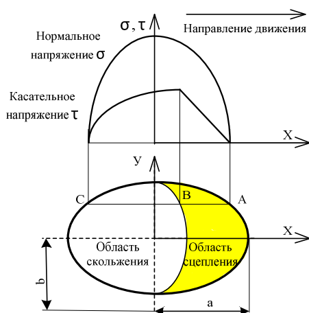
Рис. 2. Гипотеза о распределении нормальных и тангенциальных напряжений в контакте «колесо – рельс»
