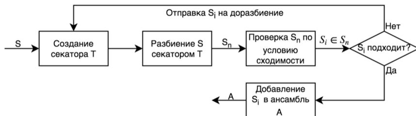
Рис. 1. Общая схема алгоритма разбиения
