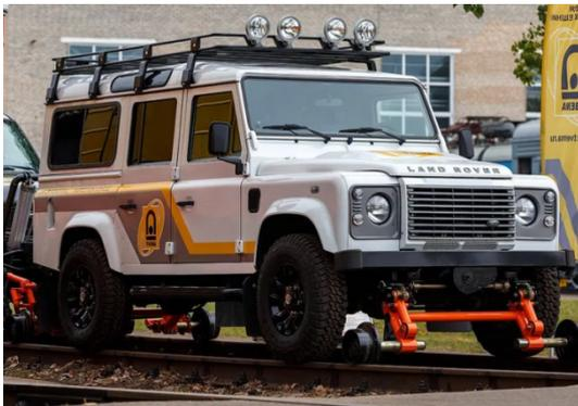
Рис. 4. Автомобиль-дефектоскоп на комбинированном ходу
