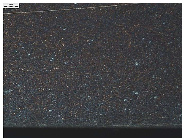
Рис. 3. Микроструктура слоя закалки ТВЧ первой коренной шейки Fig. 3. Layer microstructure of induction hardening of the first main journal
