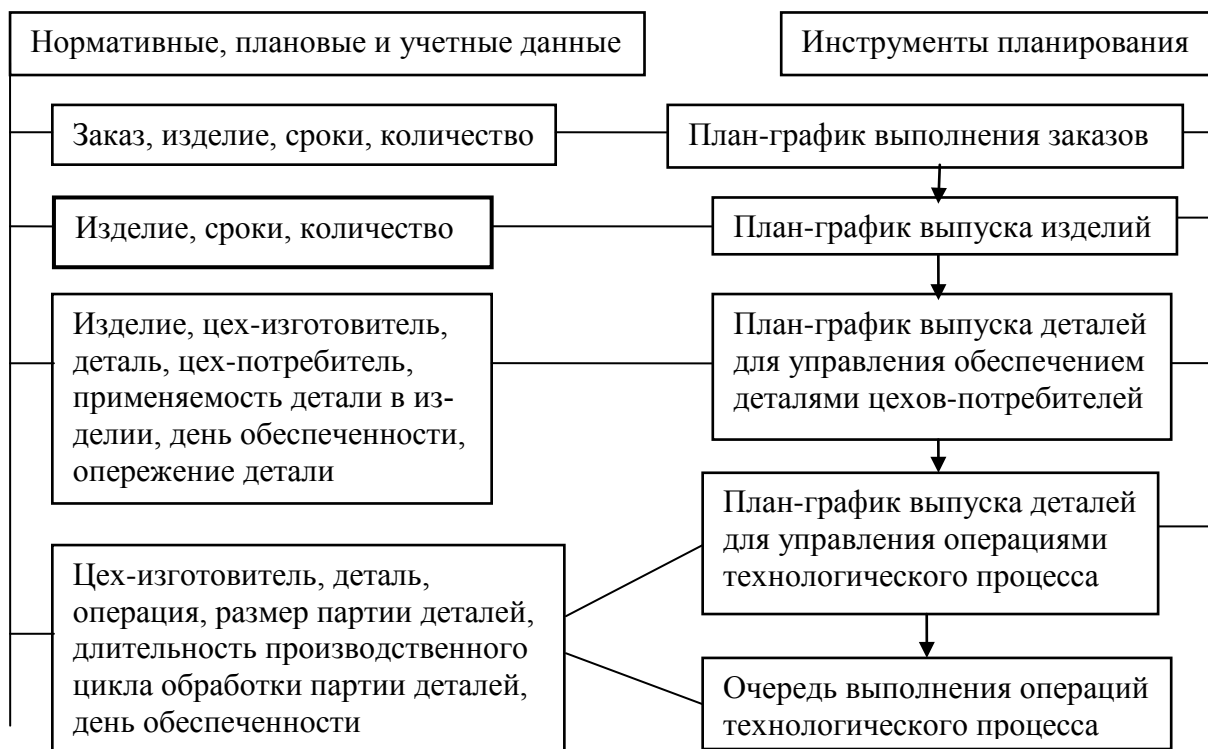
Рис. 2. Принципиальная схема универсальной системы оперативного управления динамичным разнотипным производством
