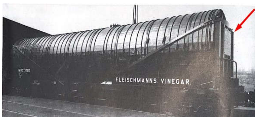
Рис. 7. Американская цистерна, снабжённая торцевыми стенками Fig. 7. American tank equipped with end walls
