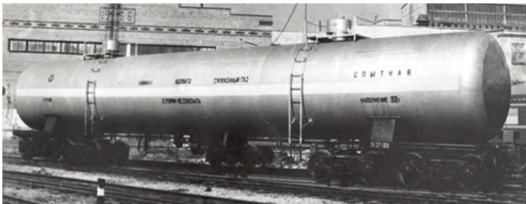
Рис. 4. Опытная восьмиосная безрамная цистерна для сжиженного газа (аммиака) Fig. 4. Experimental eight-axle frameless tanker for liquefied gas (ammonia)
