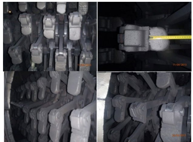
Рис. 2. Фотографии механизма ММТ и износа бил
