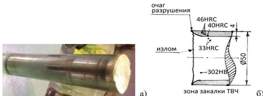
Рис. 2. Характерный вид излома шпинтона в зоне 210 на боковой раме листовой конструкции: а – внешний вид излома; б – темплет для исследования зоны разрушения
