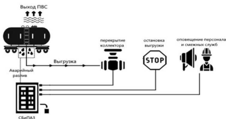
Рис. 2. Блок-схема активной защиты выгрузки нефтеналивных грузов (ННГ) Fig.2. Block diagram of active protection for oil cargo unloading (NOG)
