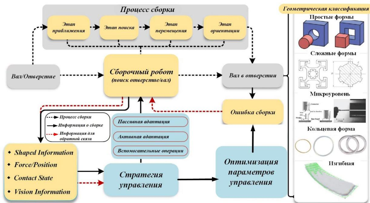
Рис. 1. Схема процесса роботизированной сборки и геометрическая классификация
