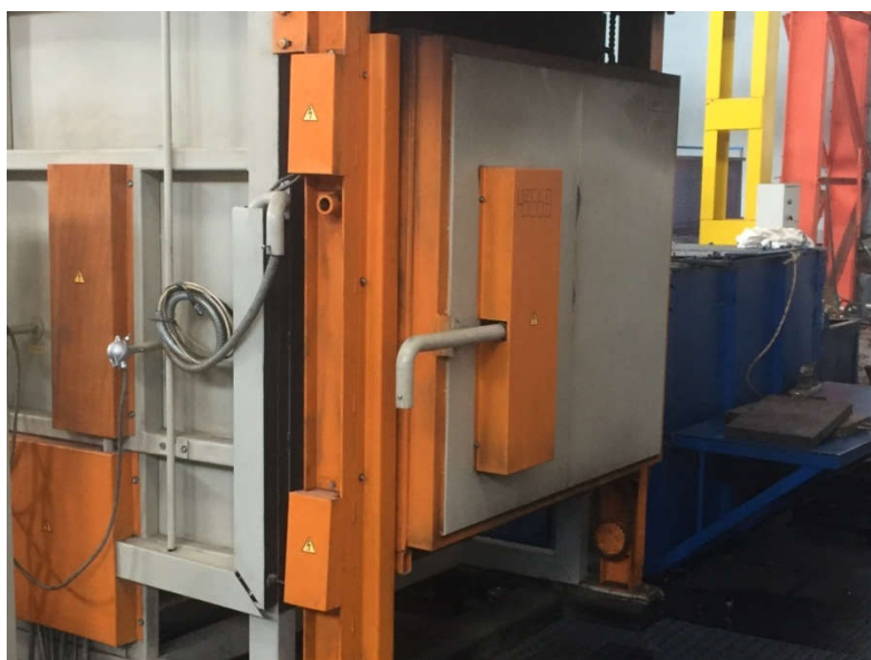
Рис. 1. Нагревательное и закалочное оборудование для отработки процесса объемного душирования винтовых пружин широкой номенклатуры
