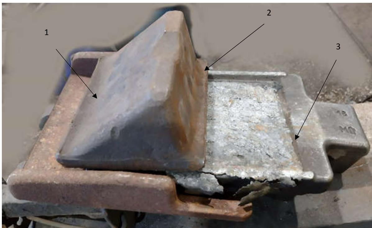
Рис. 2 Пары трения скольжения фрикционного поглощающего аппарата:
