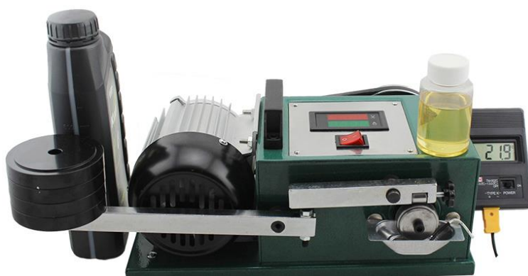
Рис. 1. Внешний вид машины для испытаний противоизносных свойств смазочных материалов по методу Райхерта Fig.1. Appearance of the machine for testing the anti-wear properties of lubricants according to the Reichert method
