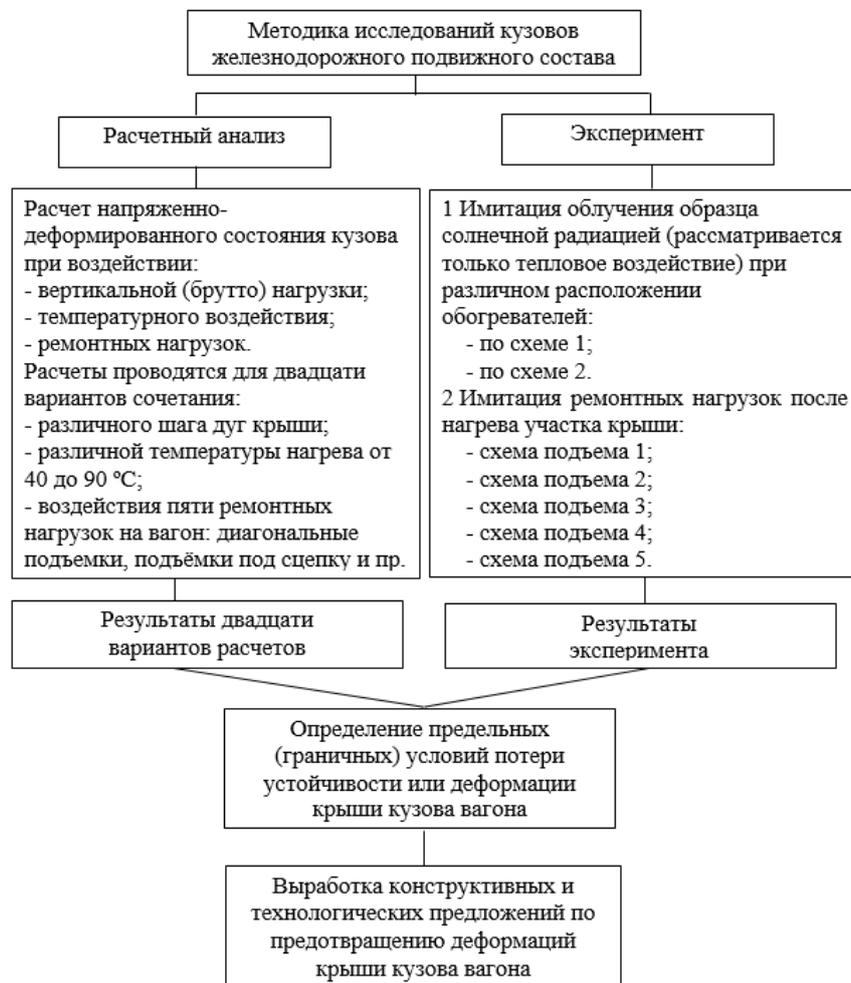
Рис. 2. Структурная схема методики
