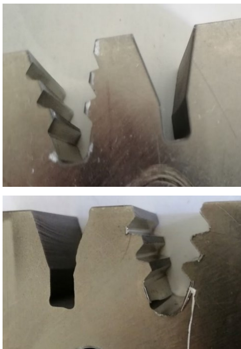
Рис. 10. Фотография образца с вырезанными предварительным и окончательным профилем пазами
