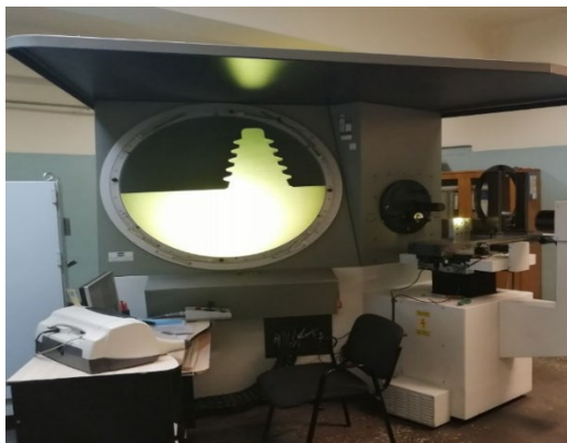
Рис. 4. Общий вид измерения точности елочных пазов в образцах дисков турбин на профильном компьютерном проекторе ST-1000
