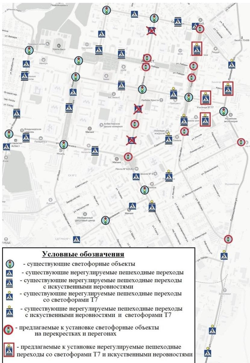
Рис. 5. Предлагаемая схема пространственного расположения технических средств организации дорожного движения на улично-дорожной сети города Асбеста (Фрагмент)
