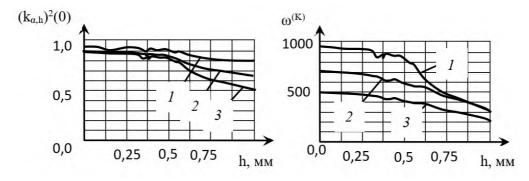
Рис. 5. Эволюция параметров функции когерентности в зависимости от износа: 1 – обработка АК-6; 2 – обработка 40XH2MA; 3 – обработка 20X
