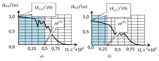
Рис. 4. Функция когерентности  $(k_{a,h})^2(\omega)$ , соответствует профилограмме фрезерования на рис. 1,2: a – износ фрезы 0...0,1 мм;  $\delta$  – износ фрезы 0,6...0,8 мм
