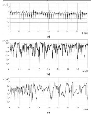
Рис. 2. Профилограммы поверхности при изменении износа зуба фрезы:
